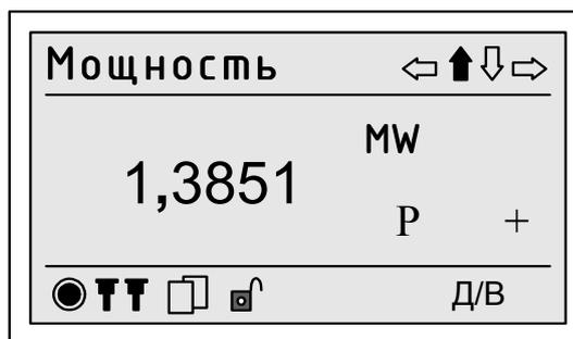
Рисунок 27 – Пример отображения на дисплее прибора характеристик мощности
