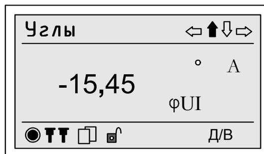
Рисунок 28 – Пример отображения на дисплее прибора углов фазовых сдвигов
