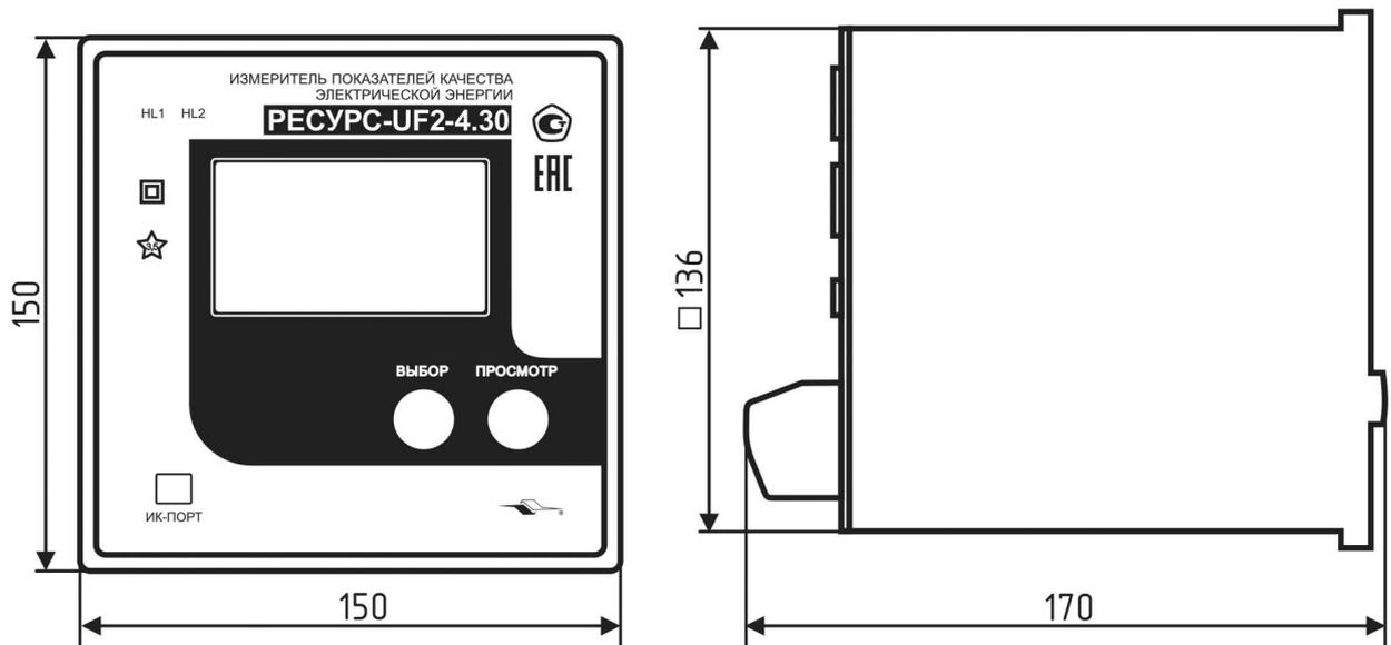
Пломба поверителя и пломба предприятия-изготовителя устанавливаются на верхней и нижней панелях прибора соответственно.
