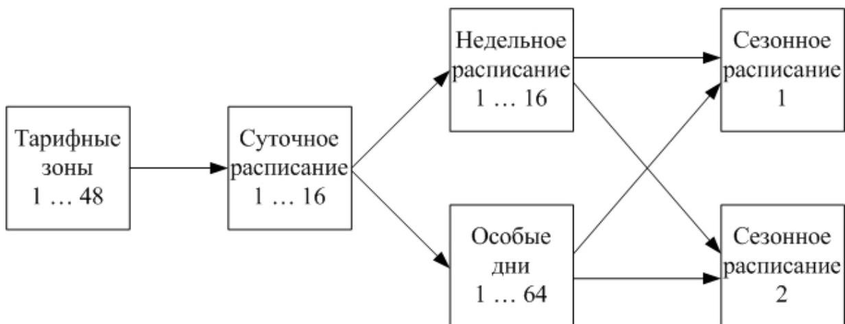
Рисунок 1 – Структурная схема организации тарифного учёта электрической энергии
