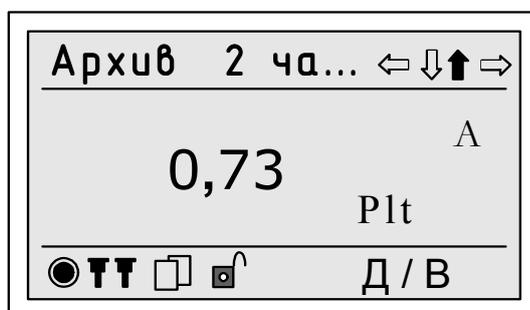
Рисунок 13 – Пример отображения на дисплее прибора результатов измерений ПКЭ на объединённом интервале времени 2 ч
