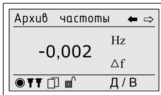
Рисунок 9 – Пример отображения на дисплее прибора результатов измерений отклонения частоты
