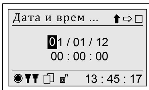
Рисунок 34 - Редактирование параметра в разделе «Дата и время»
