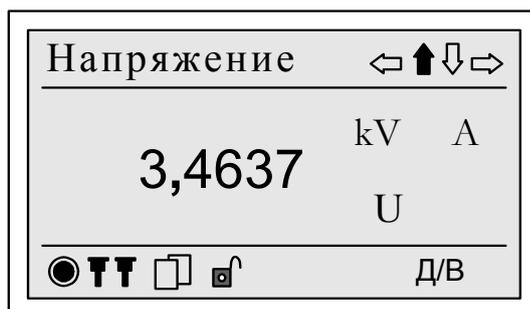
Рисунок 25 – Пример отображения на дисплее прибора характеристик напряжения
