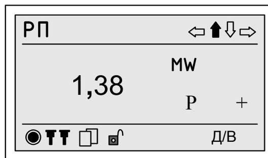
Рисунок 23 – Пример вывода результатов измерений максимальной мощности за расчётный период
