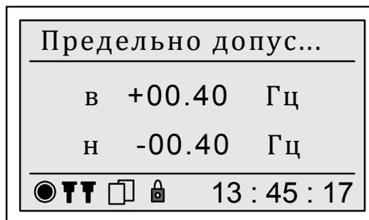
Рисунок 59 – Отображение предельно допустимых значений отклонения частоты
