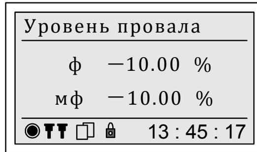
Рисунок 67 – Отображение порогового значения провала напряжения
