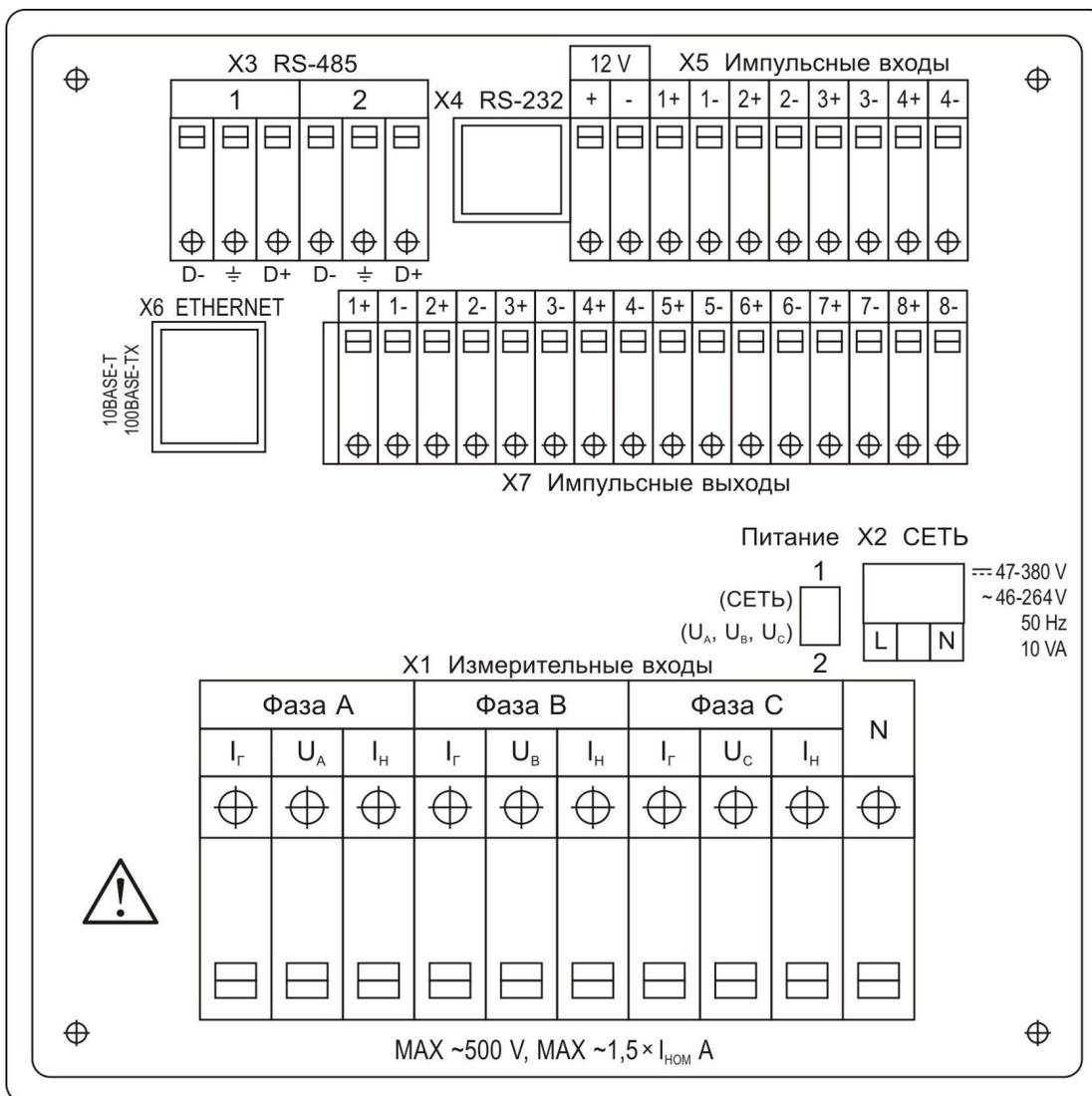
Рисунок Б.1 – Разъёмы приборов «Ресурс-UF2-4.30-Х-Х-В»
