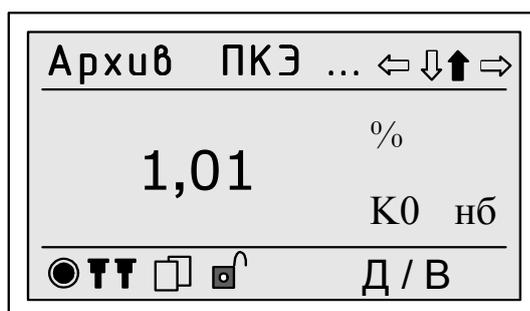
Рисунок 15 – Пример отображения на дисплее прибора значений статистических характеристик ПКЭ за одну неделю
