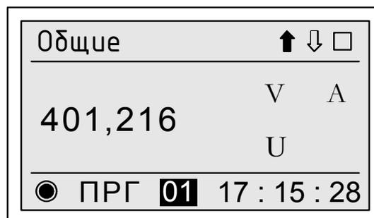
Рисунок 5б – Пример отображения сообщения о перегрузке по входу напряжения
