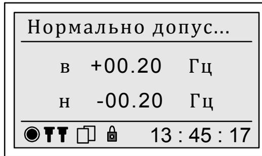
Рисунок 58 – Отображение нормально допустимых значений отклонения частоты
