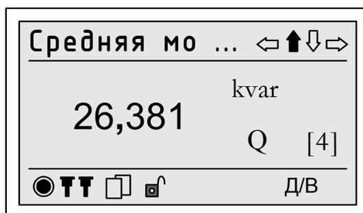
Рисунок 21 – Пример вывода результатов измерений средней реактивной мощности в квадранте 4
