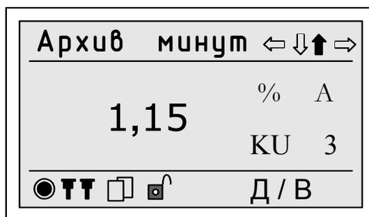
Рисунок 11 – Пример отображения на дисплее прибора результатов измерений ПКЭ на объединённом интервале времени 1 мин
