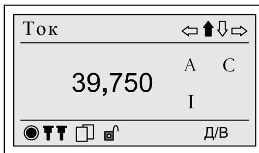
Рисунок 26 – Пример отображения на дисплее прибора характеристик тока
