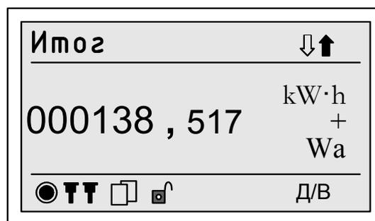
Рисунок 18 - Пример вывода результатов измерений активной энергии за все время работы прибора с момента пуска
