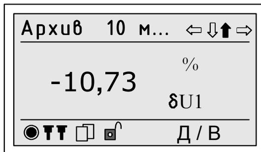
Рисунок 12 – Пример отображения на дисплее прибора результатов измерений ПКЭ на объединённом интервале времени 10 мин
